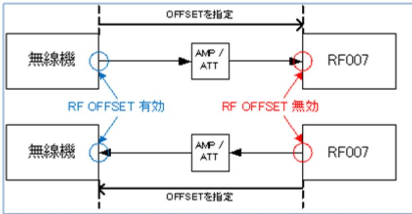
送信機試験のパワーメータや受信機試験のRF信号発生器レベルは、RF OFFSET 無効の状態では、本器のコネクタ端におけるレベルを表示・設定しています(上記赤丸)。
