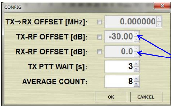
高電力無線機を測定するため、外部にATTを挿入したときやケーブルロスを補正するときに補正值を設定します。送信機試験には TX-RF OFFSET が、受信機試験には RX-RF OFFSET がチェックを入れたときのみ反映されます。ATT を挿入したときやケーブルロスを補正するときは負の値を設定します。
